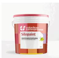
Microrivestimento murale per esterno con antialga, rende le superfici resistenti agli agenti atmosferici e idrorepellenti. A base di resine silossaniche e quarzo finissimo, permette un'ottima diffusione del vapore acqueo.
